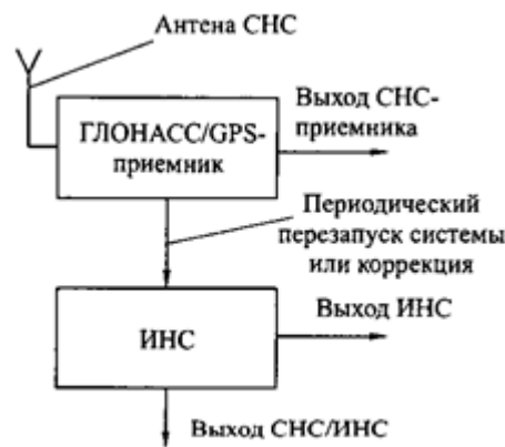
Рисунок 4 - Раздельная схема комплексирования ГЛОНАСС/GPS приемника и ИНС
