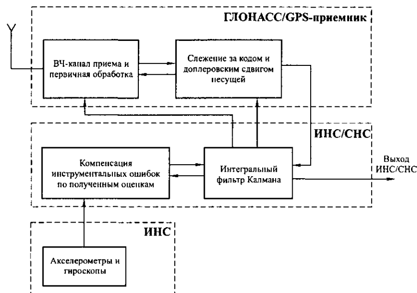
Рисунок 6 - Жесткосвязанная схема комплексования ИНС и СНС-приемника.
